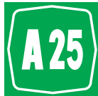
Fig. II 257 Art. 129 Segnale identificazione autostrada
