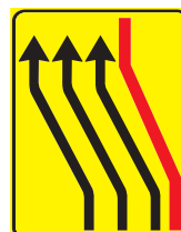
Fig. II 412/f Art. 43 Segnale di rientro in carreggiata
