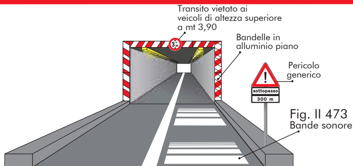
Fig. Il 470 Art. 175 Segnali su ostacoli, anomalie e punti critici stradali
