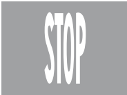
Iscrizione di STOP su strade di tipo A-B-C-D con V > 50 Km/h
