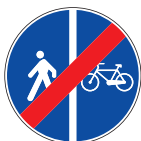
Fig. II 93/a art. 122 Fine pista ciclabile confina al marciapiede
