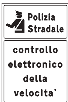
Fig. PSCEV Preavviso del controllo della velocità
